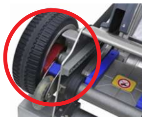
エッジブレーキシステムにより 誤作動を防ぎ落下を防止
