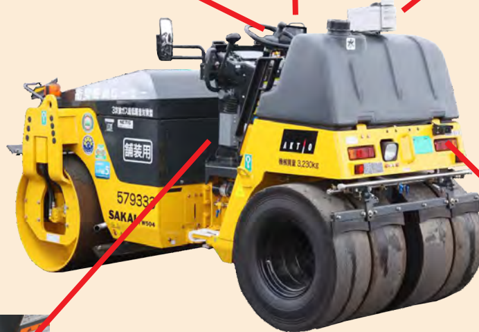
シリンダー AI カメラが後方のみを検知し、 伸長して前後進レバーをニュートラルにする
