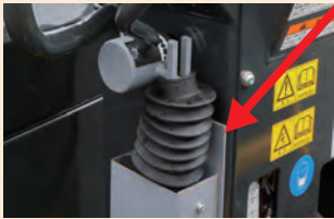
シリンダー AI カメラが後方のみを検知し、 伸長して前後進レバーをニュートラルにする
