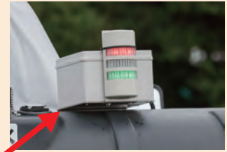
積層灯 緑=監視中、黄=注意喚起、 赤=減速 距離により変化します
