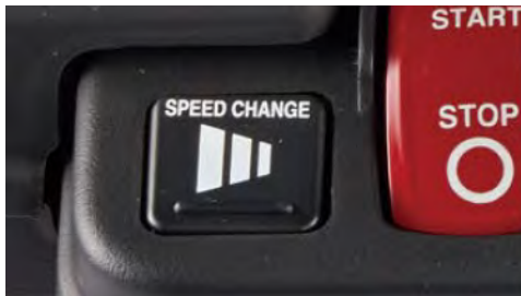
路盤状況や作業内容に応じて 選択可能な3段階スピード切替
