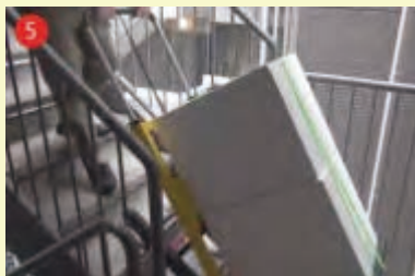
5 走行ベルト全体が階段に接触するまで傾斜
