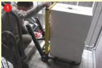
1 階段に合わせて走行ベルトの角度を調整
