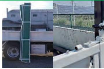
コボレーンシートはシーンに合わせて脱着可能（ボルトオン式）
