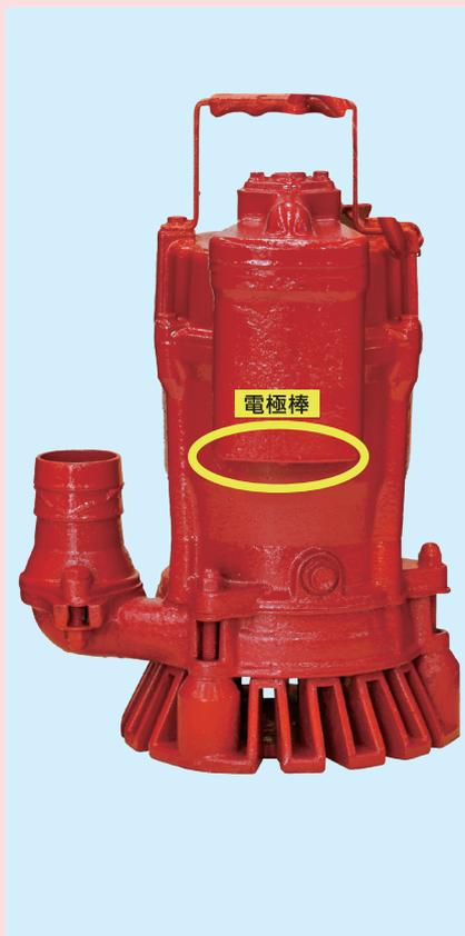
水位が高くなり電極が着水を検知すると、ポンプが作動し排水を開始。水位が下がっていき電極部が水面から離れると同時にタイマーが作動。約1分後に停止する。
