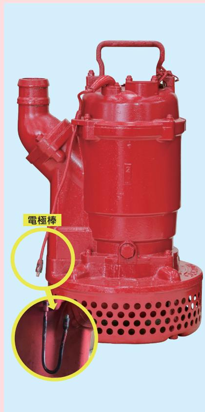
電極棒が針金ようになっており、手で曲げて簡単に水位調整が可能。内蔵マイコンで省エネ運転を行い、現場状況に合わせて空運転時間を短く、始動頻度を少なくなるようポンプが自動で調整する。
