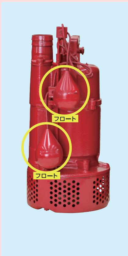
水位が高くなり上部のフロートが上向きになったら自動的にスイッチが入り、排水開始。水が汲み出されると水位が下がっていき、下部のフロートが下向きになるとスイッチがオフして停止する。
