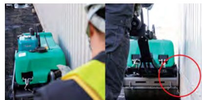
フレームとドラムの間隙が極少で位置合わせが簡単な「サイドクリアランス」
