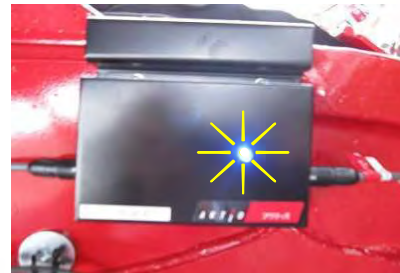
傾斜検出センサー <光(LED)で警報>
