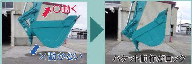
クレーン作業から掘削作業へ変更時は、クレーンフックの格納と、運転席での手動での切り替えが必須
