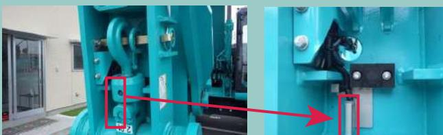
クレーンモード時には、バケットが運転席側にのみ動き、バケットシリンダーが伸びきった状態で固定
