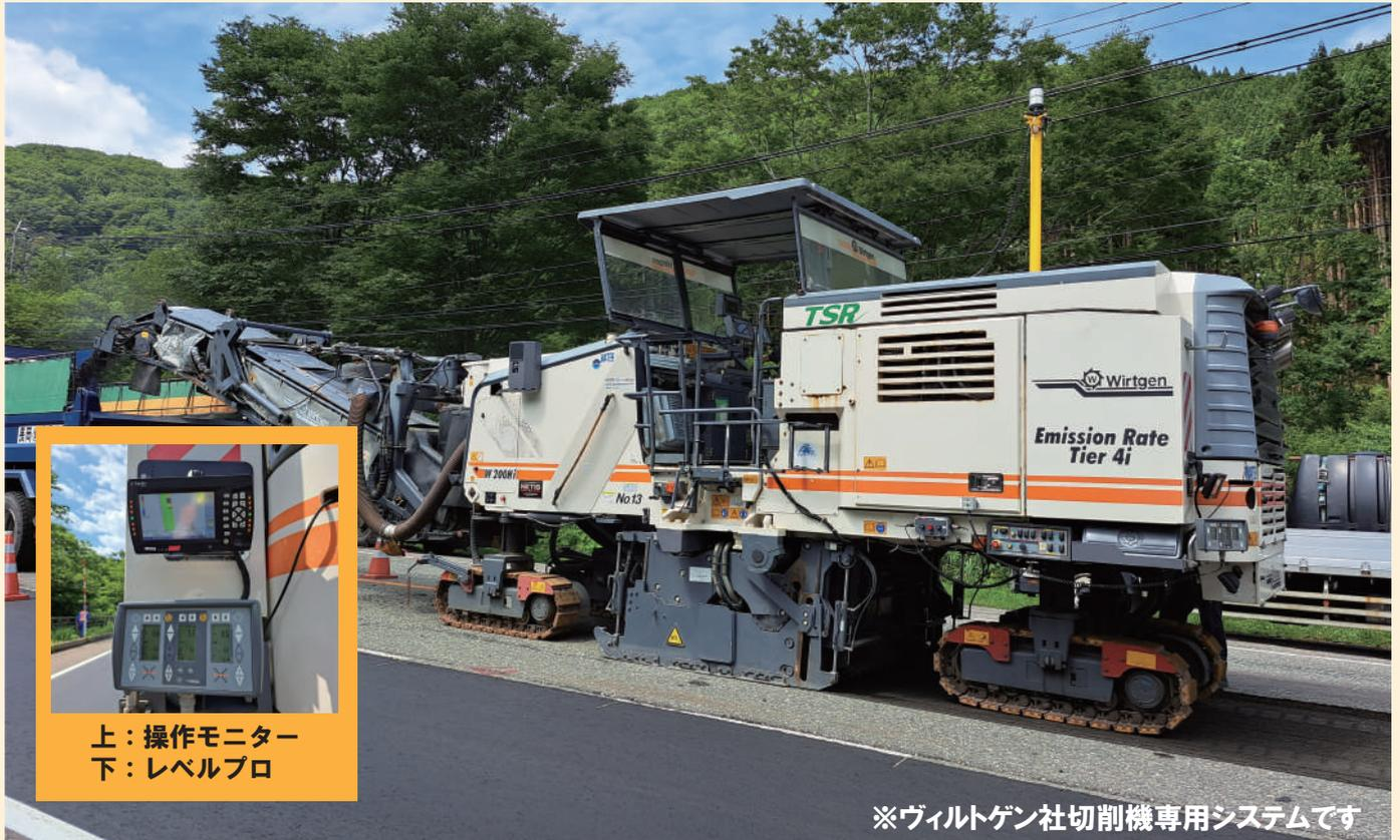
切削ドラムの刃先を自動制御するシステム。
