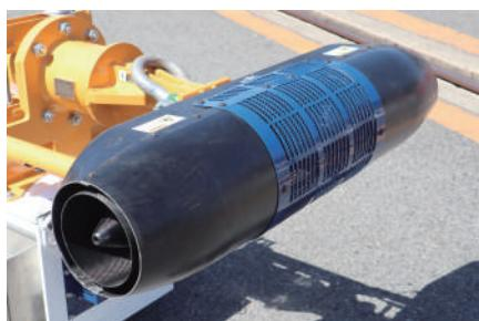
リモコンで遠隔操作(通信距離:180m)が可能
