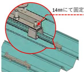
設置箇所へ仮置きする。その後、インパクト（14mmのビット）で固定する。
