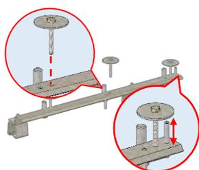
両端部の下がり止めボルトを足場板の厚みと同じにする。その後、中央のコマボルトを外す。
