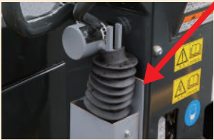
シリンダー AI カメラが後方のみを検知し、 伸長して前後進レバーをニュートラルにする
