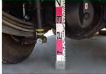
2t低床ダンプ4WDの160mmよりも+40mm高さを確保しています
