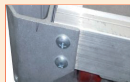
単管差込口付近はナベボルトを使用。 仕上げ壁面を傷つけない
