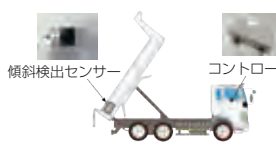
傾斜検出センサー コントローラ 架空線 角度センサーを組石で貼る 角度検出 電波 音と光で警報 運転席に受信機を設置
