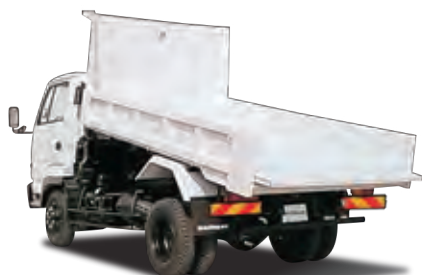
上開き式テールゲートで 積載物をスピーディーに排出 エフゲート付 リヤダンプトラック
