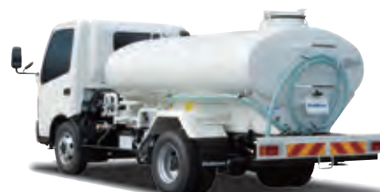
錆に強い亜鉛メタリコン 処理を施したタンク内面 散水車
