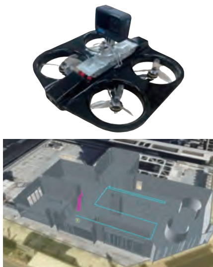
専用ソフト内で、BIMモデル上に作成したドローンの飛行経路
