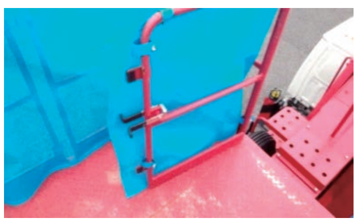
●フラップ加工(扉部) 出入口の隙間をなくしています。
