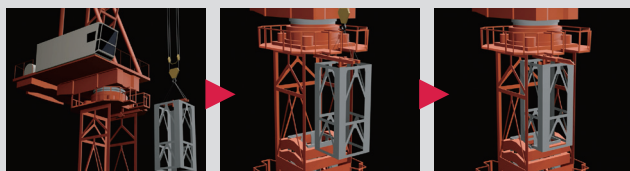
天秤を付けたタワーを 吊り上げ待機させる
