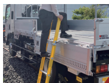
手掛かり長さ600mm突き出し可能で安心
