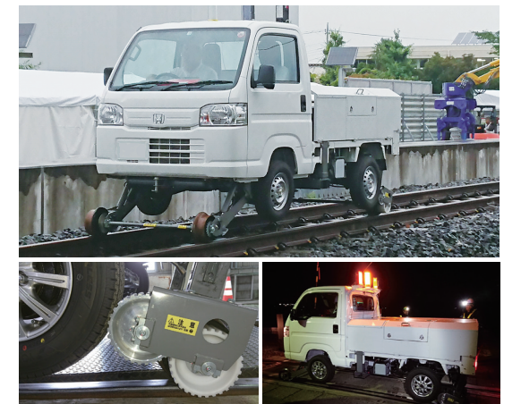
タイヤ動力で鉄輪を駆動
