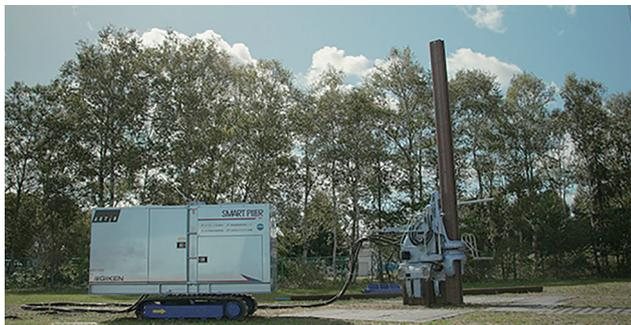
システムの全体像。左の箱形の装置は油圧パワーユニット。この一式を15t車1台で運搬できる
