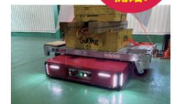
荷物の下に入り込み、ジャッキアップして、荷物の積み替えなくパレットのまま搬送が可能
