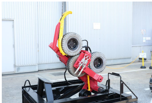
治具を作動させ、本体が吊り上がった状態にする (本体を吊った重量がワイヤーのテンションになる)
