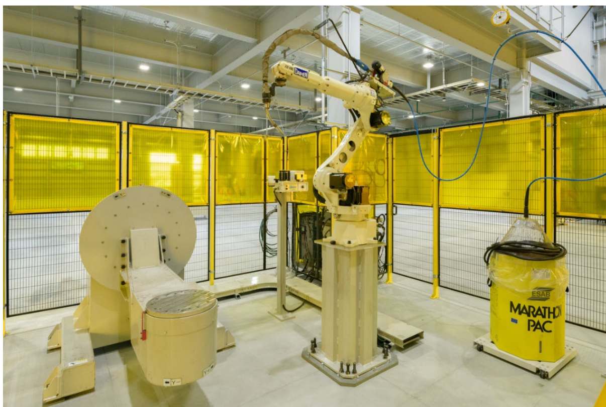
【自動溶接ロボット】
