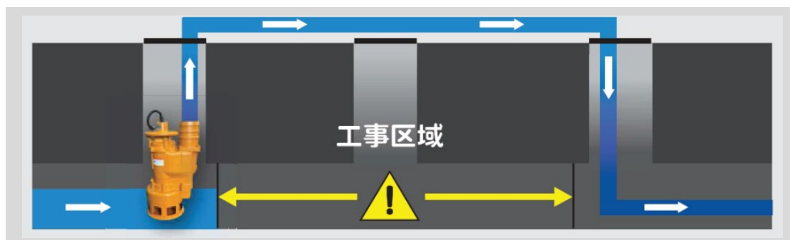
【下水道のマンホール切り回し工事】
