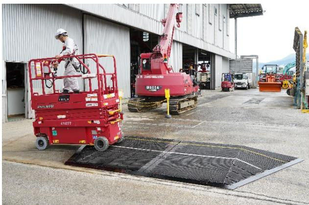
一方向に通過するだけで、前傾斜・後傾斜・横傾斜の点検ができる。工場内の高所作業車の「通り道」に設置することで、常時、効率的な点検が可能となった。
