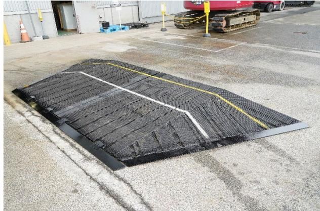
今回作成した点検台は、高所作業車が一方に点検台を通過するだけで、前傾斜と後傾斜に加え、これまで難しかった横傾斜の点検も連続して行えます。室内系高所作業車の中で最も大きな9.9mタイプにも対応する大きなサイズとなっており、タイヤやクローラがスロープから外れ転倒するリスクを大幅に軽減することができました。また、Uターンの手間もなくなり、効率化にもつながりました。
