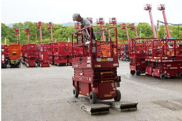
車幅に合わせて置いた2台のスロープに乗り上げて傾斜点検。熟練が必要、かつ転倒のリスクがあった。
