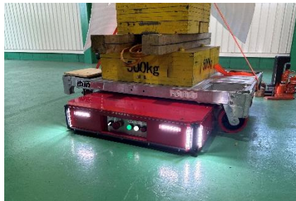
②荷物の下に潜り込み ジャッキアップしそのまま台車ごと 搬送可能
