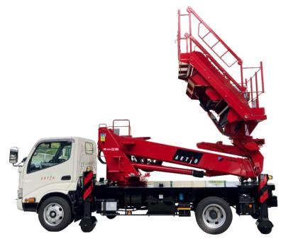
今回の「トンネル点検プラットフォーム」は、トンネル点検作業の効率化と作業員の作業負担軽減を目的 に開発された高所作業車です。最大の特徴は、プラットフォームの作業台をトンネルのアーチに沿うよう階 段状に変形する仕様にしたことで、点検の際に一度に広範囲の点検作業を行うことを可能にしました。
