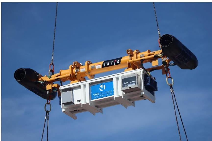
「ビタロードナビゲーター」は、橋脚、護岸、土木工事などで使用するクレーン作業の安全性と作業効率を高める機械装置です。近年、老朽化による橋脚の架け替え工事が増加しており、より安全に、より効率よく作業を進めることが重要になってきています。
