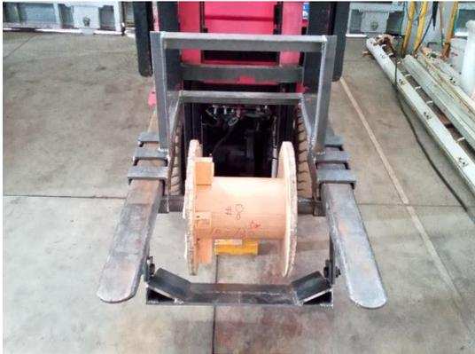
フォークの重量とドラムのアームで連結した鉄板でブレーキを掛けられるように改良
