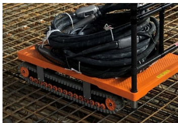
配筋の上も走行可能
