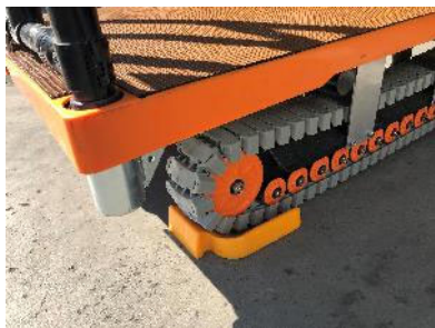
輪止めを完備
