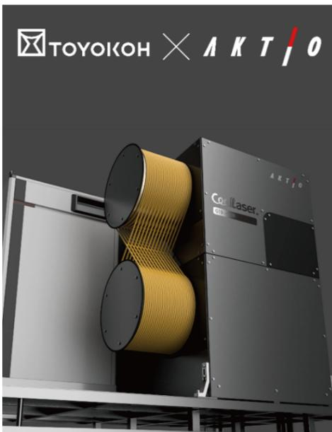
近年、インフラの老朽化は先進諸国を中心に世界を悩ませ、特に少子高齢化が進む日本では、メンテナンス工事の担い手が年々減少する社会課題を抱えています。「CoolLaser」はレーザー処理のため、発生する産廃物は除去対象物に限られ、レーザーヘッド先端部に取り付けた集塵ホースから粉塵を瞬時に吸引するため、従来工法にはない、非常にクリーンな作業環境を実現します。さらに、サビの原因となる塩分も乾式で除去でき、防食便覧で推奨される 80μmRzJIS 以下の適度な表面粗度が得られます。これまでの塗替工事は塗膜除去(湿式等)、塩分除去(水洗い等)、素地調整(ブラスト等)と各工程に別の装置を設置する必要がありましたが、「CoolLaser」は 1 台で完結することが可能です。また、速やかに次の塗装作業に移ることができるために、再劣化の原因となる塩分の再付着・戻りサビの発生を抑制し、塗替工事の回数低減により、人手不足の解消につながります。
