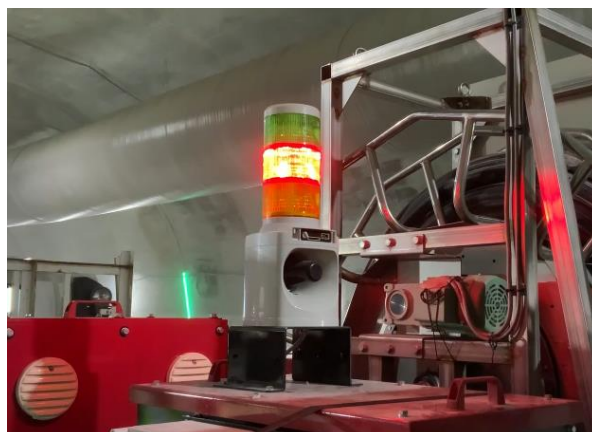
写真8 異常発生時警報装置(音声連動)
