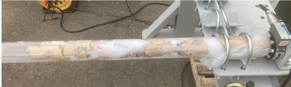
写真3 密装填状況(装薬孔内で圧縮された紙巻含水爆薬)
