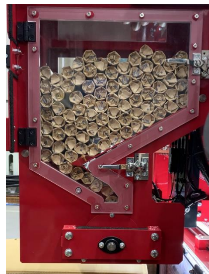
写真6 ホッパー内への爆薬格納状況
