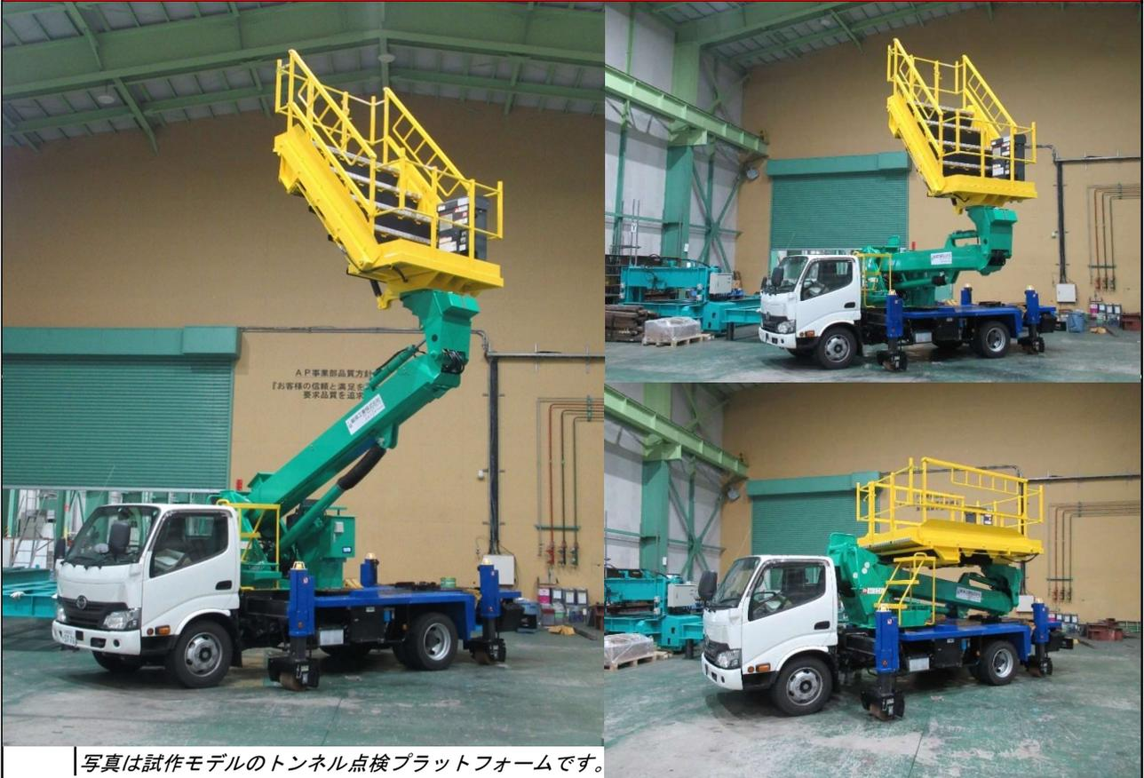
写真は試作モデルのトンネル点検プラットフォームです。
