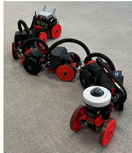
※地下ピット自律点検用ヘビ型ロボット(仮称)は、大末建設㈱と電気通信大学が共同開発したロボット(裏面ご参照)で、アクティオが商品化に向けて連携、サポートしています。
