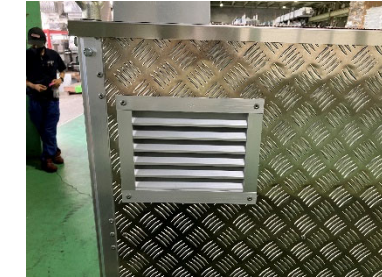
背面にはガラリによる排気口 (ガラリサイズ:250mm×200mm)
