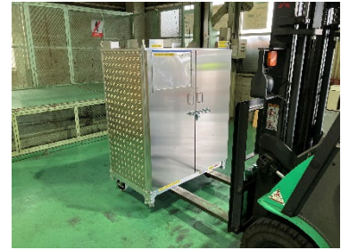
フォークリフトでの移動が可能 (段差等を気にせず搬入が可能)
