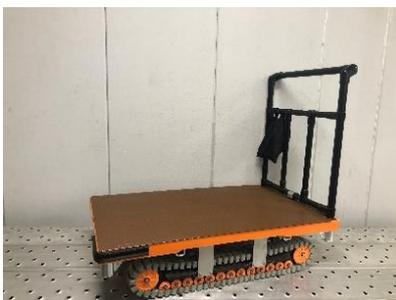
「アクロス AKT-600」は、建設現場や土木現場など、様々な路面環境で荷物の搬送を可能にするクローラー型の台車です。配筋、デッキプレートの上、敷鉄板の段差などはもちろん、アスファルト・コンクリート・砂利・土・泥・石畳・砂・草・雪など、今までキャスター式の台車では難しかった運搬シーンでスムーズに荷物を運ぶことが可能になります。
