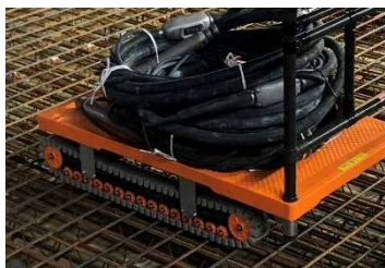
配筋の上も走行可能
