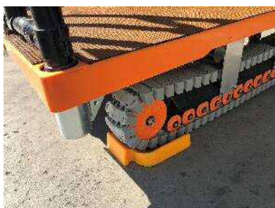
輪止めを完備
