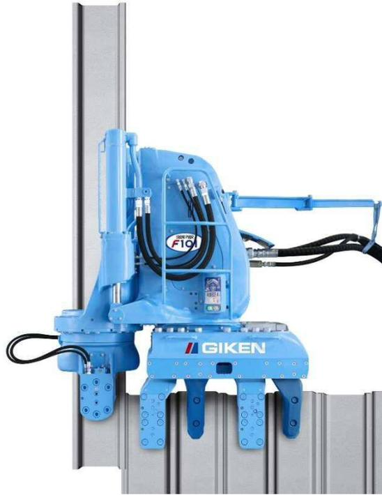
※1すでに打ち込まれた杭をつかみ、その引き抜かれまいとする抵抗力(反力)を利用して機体を固定し、油圧による静荷重で次の杭を押し込む原理です。打撃式や振動式の杭打ち機と異なり、周辺住民や環境に影響を与える振動、騒音が発生しません。杭を圧入すると機体を上に持ち上げる反作用力が働くことから、例えば100トンの圧入力をかけた場合、通常ならば機体を固定するのに100トン以上の重量が必要となり、機械は巨大になってしまいます。一方、圧入原理を用いる「サイレントパイラー®」は自重に頼らずに反力を活用して機体を固定するため軽量、コンパクトで、都市部や住宅地でも建設公害を出さずに施工が可能です。
