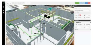
BIMの3Dモデル配置、航路設計を行える「SENSYN CORE(センシンコア)」。大規模な建設現場での自立飛行に欠かせないプラットフォーム
