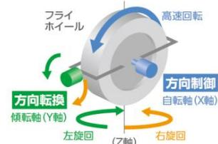
内部で重たい円盤を高速回転させ、円盤にかかる強い慣性の力「ジャイロ効果」を利用し方向を制御しています。また円盤を傾けることで自在に方向転換できます。
