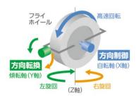
内部で重たい円盤を高速回転させることで、円盤に強い慣性の力がかかり、機械全体の方向を制御することが可能。また、円盤を傾けることで自在に方向転換が可能。
