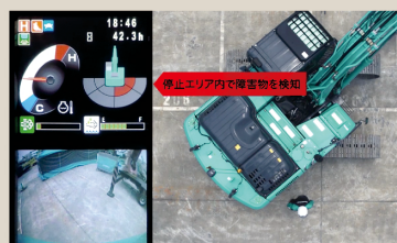
停止エリアで検知した場合 ▶ 自動で停止+アラーム
