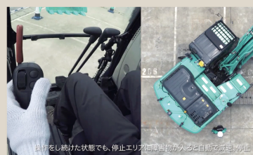
停止エリアで検知した場合、操作を続けても自動停止
