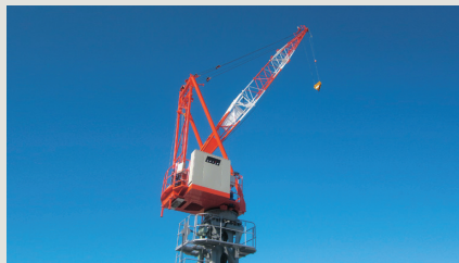
タワークレーン
