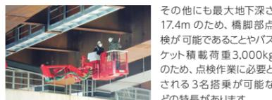
その他にも最大地下深さ17.4mのため、橋脚部点検が可能であることやバスケット積載荷重3,000kgのため、点検作業に必要な3名搭乗が可能などの特長があります。
