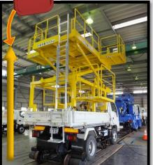
・上下各2ヵ所のはねだし床を装備 共に許容荷重150kg
