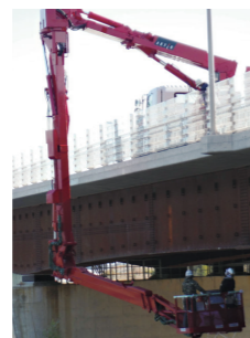
橋梁点検の作業効率向上のため、ローラ付アウトリガを採用。作業状態での走行が可能。また、3.5m歩道越えの作業が可能。
