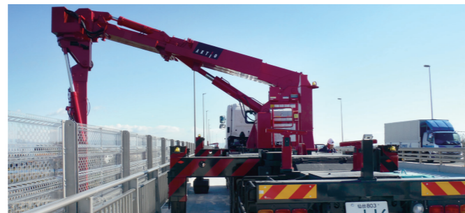
橋梁点検の作業効率向上のため、ローラ付アウトリガを採用。作業状態での走行が可能。また、3.5m歩道越えの作業が可能。
