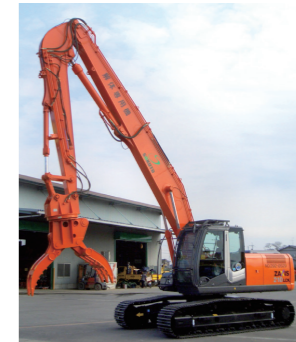
解体用バックホー
