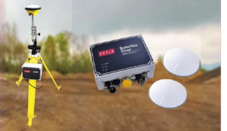
AKTIOが独自開発したICT建機・機器向けのGNSS受信機と高精度な補正データ情報を提供するオリジナルサービス「Satellite Shot」。最大の特長は、従来の無線ではなく基地局と移動局間の通信にLTE回線を使用している点。山や建物などの障害物の影響を受けることなく、半径10km程度の広範囲で安定した通信が可能となった。
