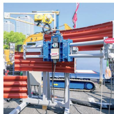
送電線鉄塔建設などの基礎工事で、土留め材として使用されるライナープレート(約30kg)は、従来2人の職人が手作業で取り付けを行っており、深さ20mで100枚を超える取り付け作業は重労働で、ケガのリスクも高かった。本取付装置は1人作業であっても安全に操作を行うことができ、安全性の向上と作業負担の軽減を同時に実現できる。実際に取り付けを体験した来場者からも簡便な操作性に驚きの声が上がっていた。
