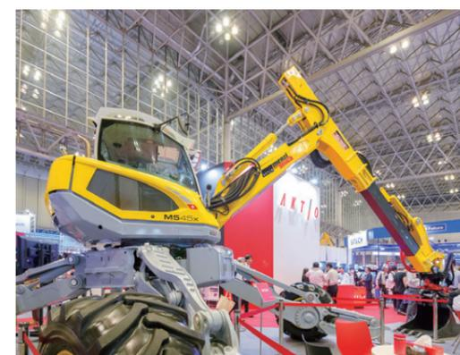
不整地や傾斜地でも高い登坂能力と機動性、作業性能を発揮する機械。急斜面や狭い現場、防水性の高さから河川内での作業も可能。主に林業や災害復旧、河川・護岸工事、土木工事などで活躍が期待されている。
