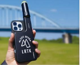
LRTK Phoneは、iPhoneに専用アンテナを取り付けることで、誰でも簡単にcm精度での3D測量を可能にする画期的な簡易型モバイルスキャナ。LiDARセンサーと写真測量を組み合わせた高精度な点群スキャンから、LiDARのみでの迅速なスキャンまで、現場のニーズに応じたデータ取得が可能。
