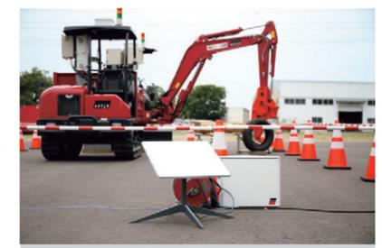
操作信号は、光回線、「Starlink」の衛星を経由して、現場に設置された「Starlink」のアンテナに送られる。
