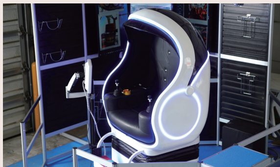
【専用コックピット】 タワークレーンの運転席回りに設置された複数台のカメラによって撮影された映像が、基地局を経由して地上(または遠隔地)にあるコックピットに送信され、モニター画面に映し出される。また、荷重などの動作信号及び異常信号を閲覧する専用モニターも設置している。
