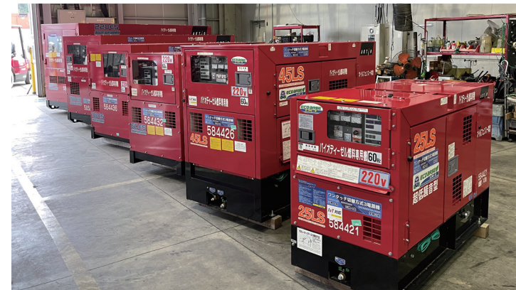
バイオディーゼル燃料専用発電機
