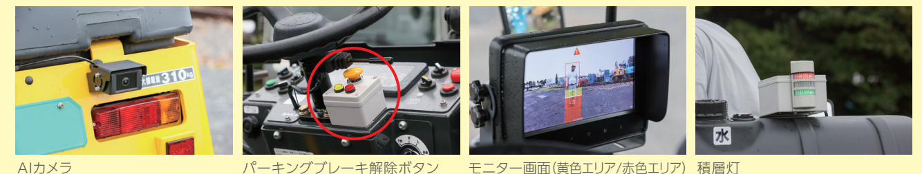
AIカメラ パーキングブレーキ解除ボタン モニター画面(黄色エリア/赤色エリア) 積層灯
