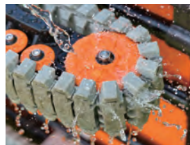
クローラー部分の丸洗いが可能
