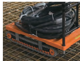
配筋の上も走行可能
