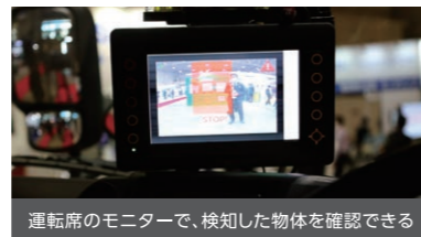
運転席のモニターで、検知した物体を確認できる
